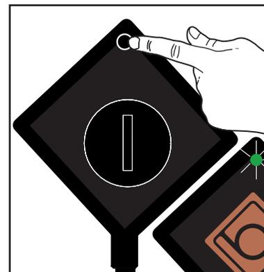
Si la sonde clignote en vert, faites un appui bref de 1 seconde
